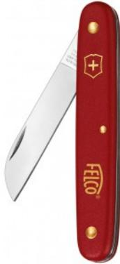
Cuchilla para injertos con hoja recta y cuchillo de esquejar. Pequeña y resistente. Mango de nailon rojo con forro de aleación estándar. Hoja de acero inoxidable, biselada en una cara, herramienta para diestros, hoja de 57 mm. Herramienta adaptada a los injertos en corona o a la preparación de esquejes
