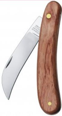
Cuchilla para injerto con forma curvada. Herramienta resistente de tamaño medio. Mango de madera de frondosa con forro macizo de latón. Hoja de acero inoxidable, biselada en una cara y ligeramente curvada. Herramienta para diestros, hoja de 70 mm.
