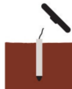
Conectar el cable interno del tubo a la parte superior de la unidad.
